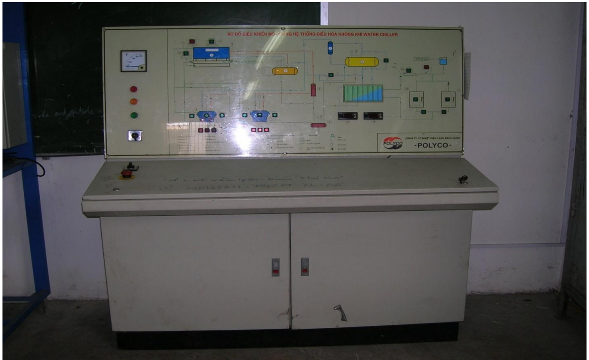
Mô hình mô phỏng làm việc của hệ thống điều hoà không khí trung tâm
